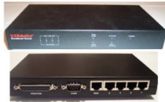
Router, aspecto delantero y posterior
