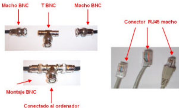
Conectores para redes, BNC y RJ45
